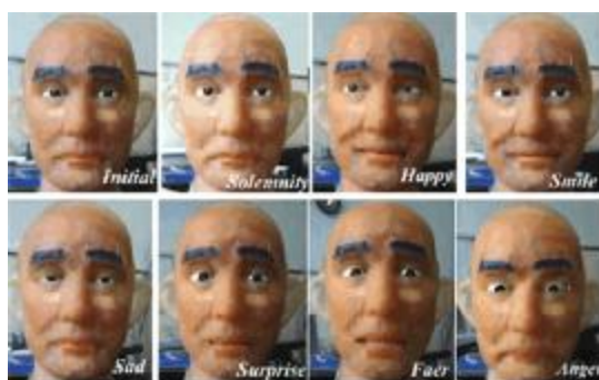
(a) F&Hrobot-I 实现的 8 种面部表情 [127]
