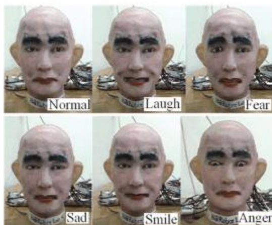
(b) F&Hrobot-II 实现表情视觉识别后的表情再现 [128]
