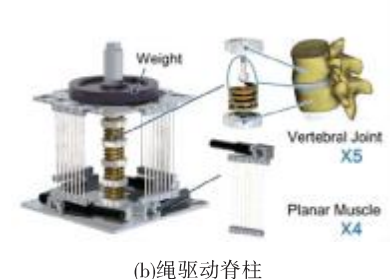
图 9 绳驱动脊柱及其驱动原理 [72-73]
